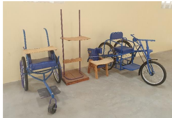
Beispiele von gefertigten Hilfsmitteln Rollstuhl, Stehtisch, Stuhl für Kinder mit Zerebralparese, Dreirad
